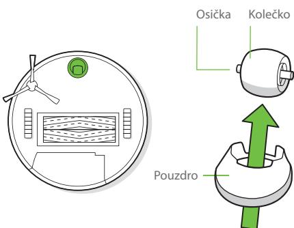
**Důležité:** Přední kolečko zanesené chlupy a nečistotami může poškodit podlahu. Pokud se kolečko po čištění volně netočí, kontaktujte oddělení péče o zákazníky.
