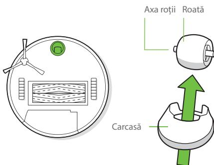
**Important:** Blocarea roții frontale cu fire de păr și reziduuri poate duce la deteriorarea podelei. Dacă roata nu se rotește liber după ce ați curățat-o, contactați Departamentul de relații cu clienții.
