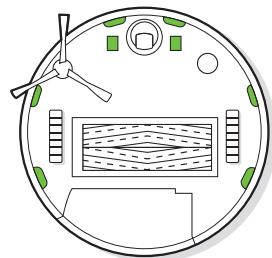
**Důležité:** Nestříkejte čisticí prostředky ani vodu přímo na senzory nebo do otvorů pro senzory.
